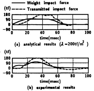
図-3 各衝撃力の時刻歴波形
