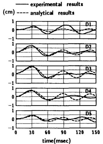
図-4 覆工頂版の鉛直変位波形
