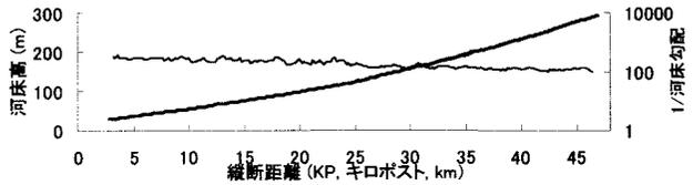
図-2 札内川の河床縦断面図
