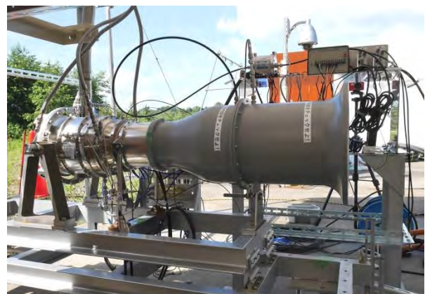
図2 エンジン架台に設置された GG-ATR エンジン
