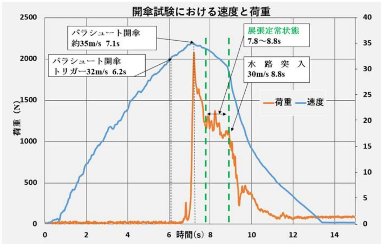
図6 2017年2月の開傘実証試験結果
