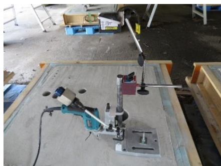
写真 5.4.3 振動ドリル削孔時の消費電力と削孔深さ測定
