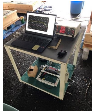
写真 5.2.4 削孔時消費電力測定状況
