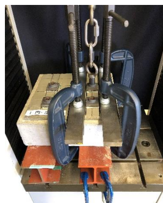
写真 5.3.2 接着強度試験状況
