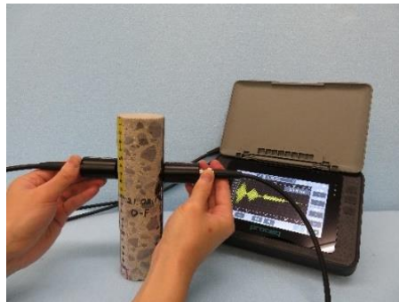
写真 5.4.5 コア側面の超音波伝播速度(透過法)測定状況
