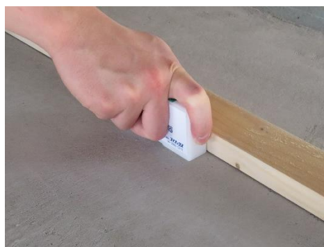
写真 5.4.2 引っかかり試験状況
