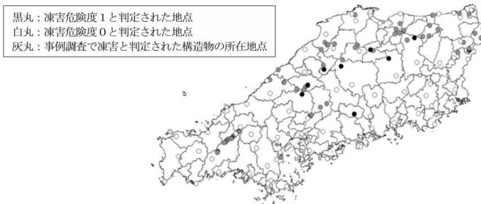
図 1.2.2 中国地方における凍害危険度と凍害構造物の所在地点<sup>1.22)</sup>
