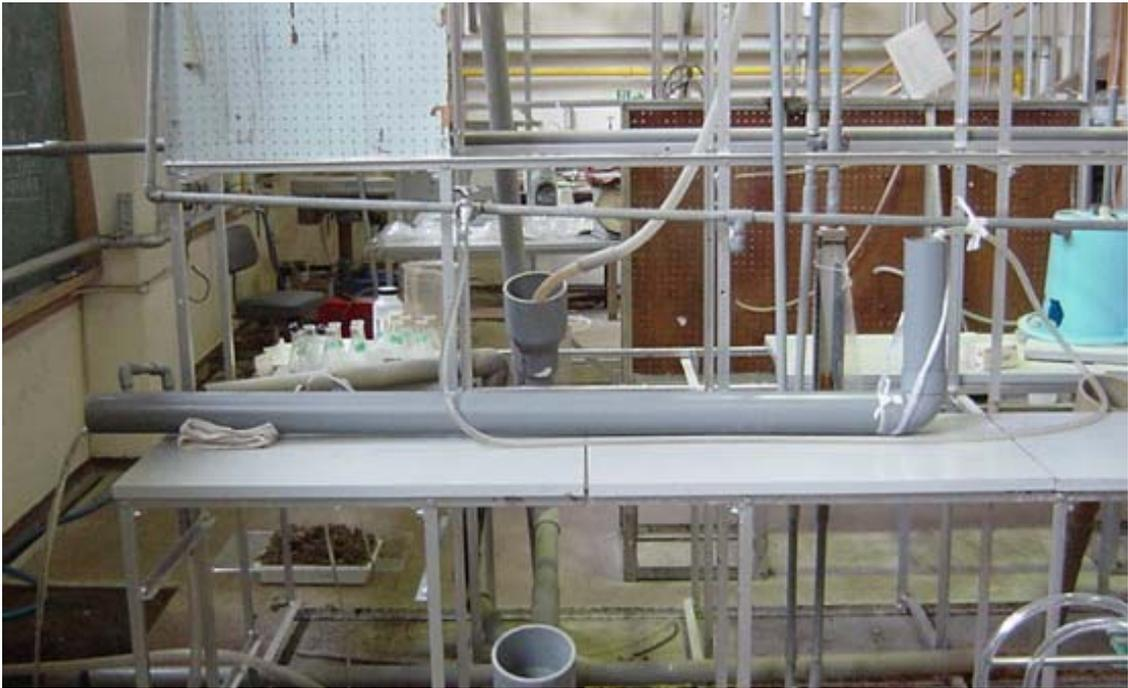
写真 6.2-2 流量検定用パイプライン(呼び径 75 mm)
