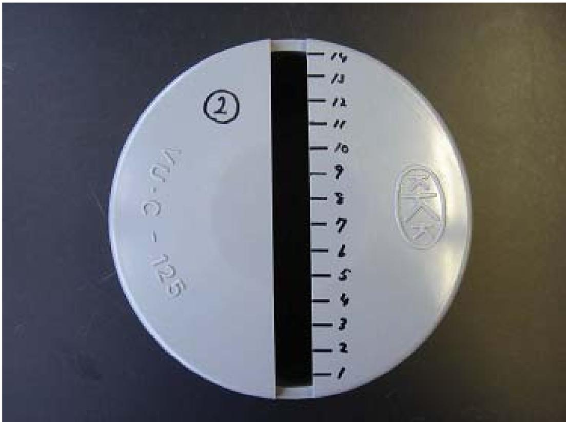
写真 6.2-1 堰式流量計(呼び径 125 mm)
