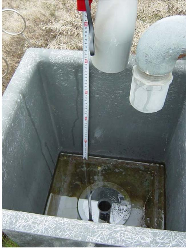
写真 6.3-4 現地試験(オリフィス板設置状況)
