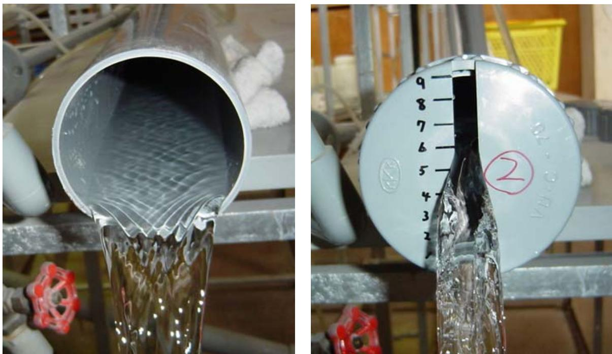
写真 6.2-5 流量検定(呼び径 75 mm, 流量  $0.35 \text{ L}\cdot\text{s}^{-1}$ )
