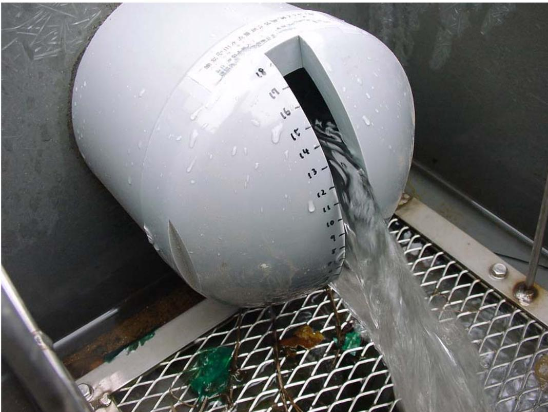
写真 6.2-7 屋外実験用堰式流量計を用いた取水試験(呼び径 125 mm, 堰幅 20 mm)
