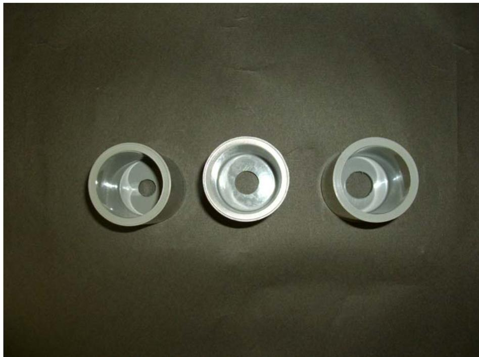
図 6.4-4 孔付き水道用キャップ(呼び径 25 mm,  $\theta=0^\circ$ )
