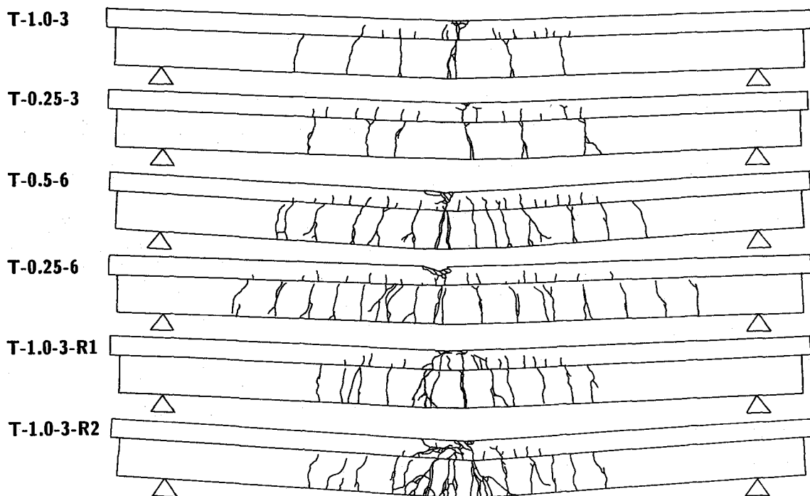
図-3 静載荷実験終了後の各 PRC 梁のひびわれ状況図
