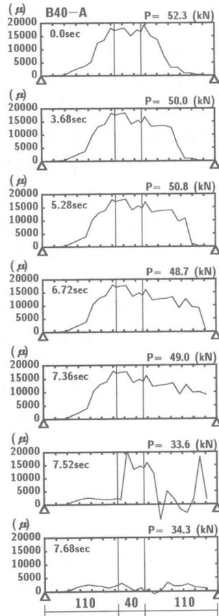
図-4 FRP シートの剝離挙動 (cm)
