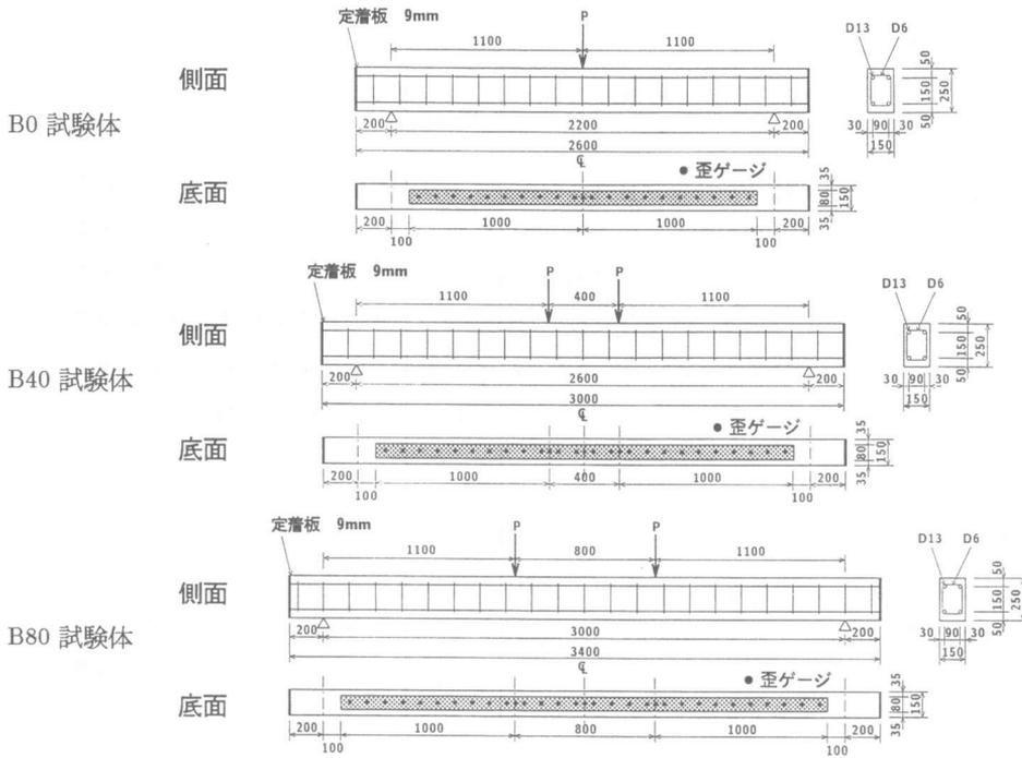
図-1 試験体の概要
