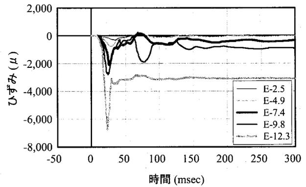
図-12 コンクリート上縁ひずみ波形
