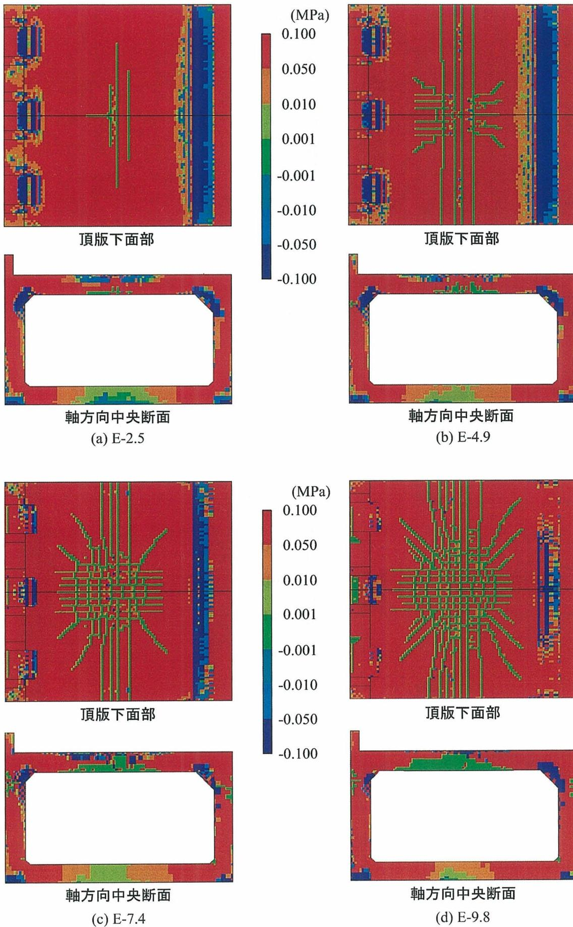
図-13 解析結果のひび割れ分布
