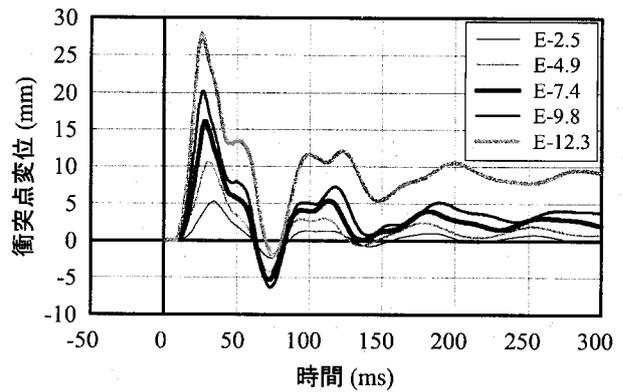
図-10 衝突点直下変位波形
