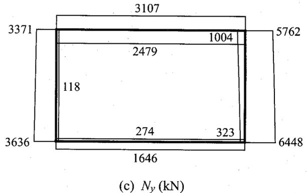
図-2 道路軸直角方向設計断面力
