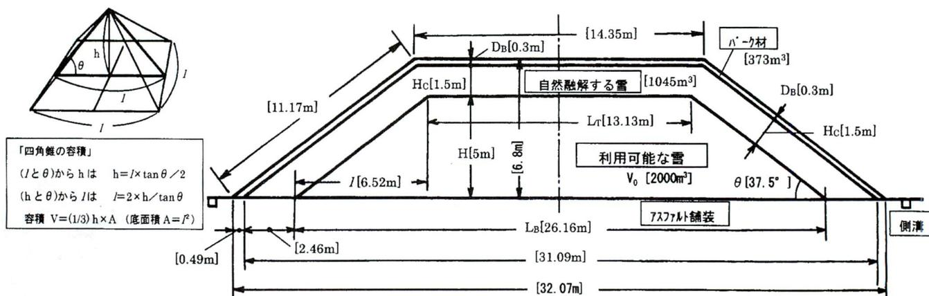
Fig. 2.4 雪山の主要寸法例 ( $V_0=2000\text{m}^3$  の場合)
