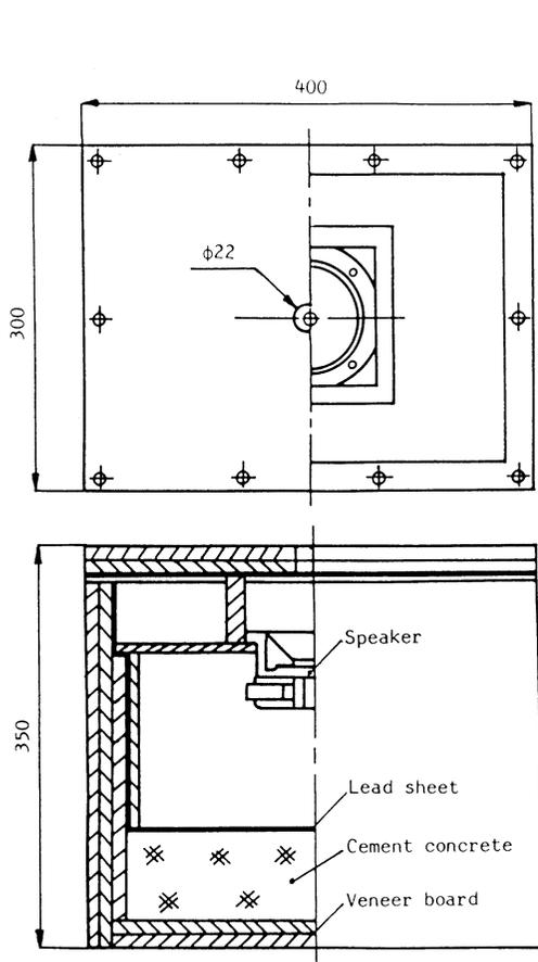
図-2 1面放射のエンクロージャモデル
