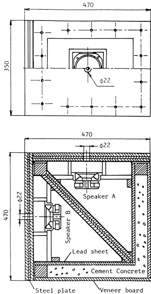
図-3 2面放射のエンクロージャモデル
