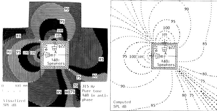
図-9 315Hzの純音による2面放射モデル周囲の音圧レベル分布
