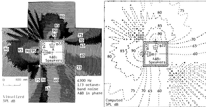
図-13 中心周波数6300Hzの1/3オクターブバンドノイズによる
