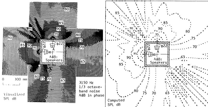
図-11 中心周波数3150Hzの1/3オクターブバンドノイズによる
