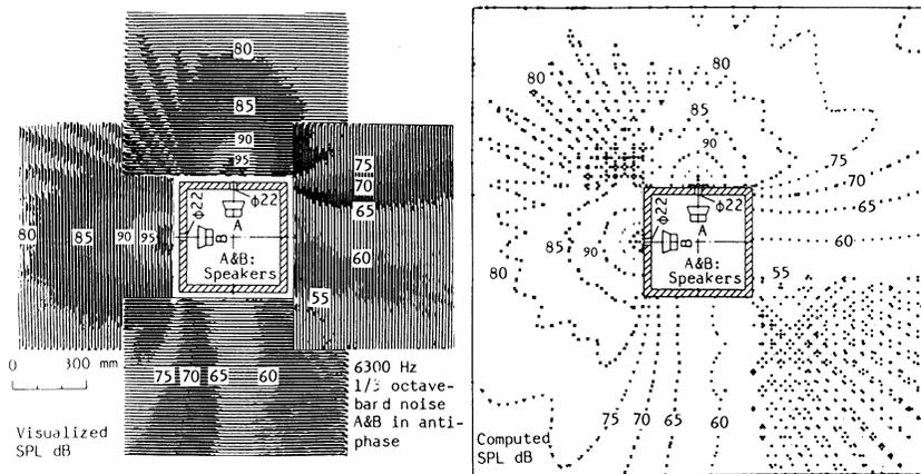
図-14 中心周波数6300Hzの1/3オクターブバンドノイズによる
