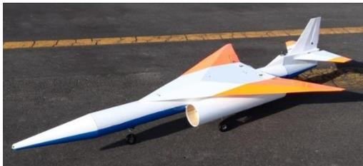
図 21. 試作された第一世代実験機の縮小機体 (M2006prototype 形状、縮小比 1/2)
