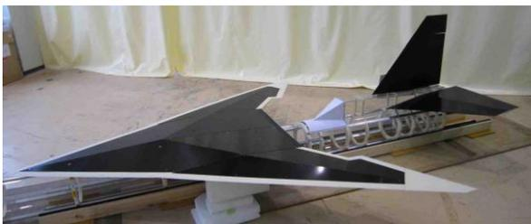
図7 モックアップ (主翼および胴体後部)
