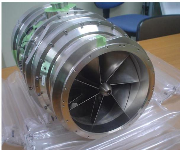
図 8 製作した GG-ATR エンジン
