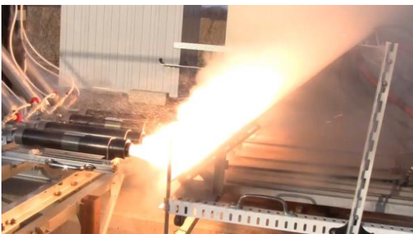
図 3 フルサイズ軌道用推進装置（ハイブリッドロケット）
