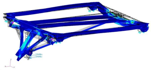
図 1 2 NASTRAN による構造解析の結果。カラーマップは左下部に水制動時の荷重が負荷された場合の Mises 応力。
