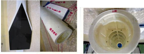
(a) 上面 (b) 下面 (c) 中央胴体内部 図10 翼胴一体型構造部の1/2スケールモックアップ（樹脂3Dプリンタ製）
