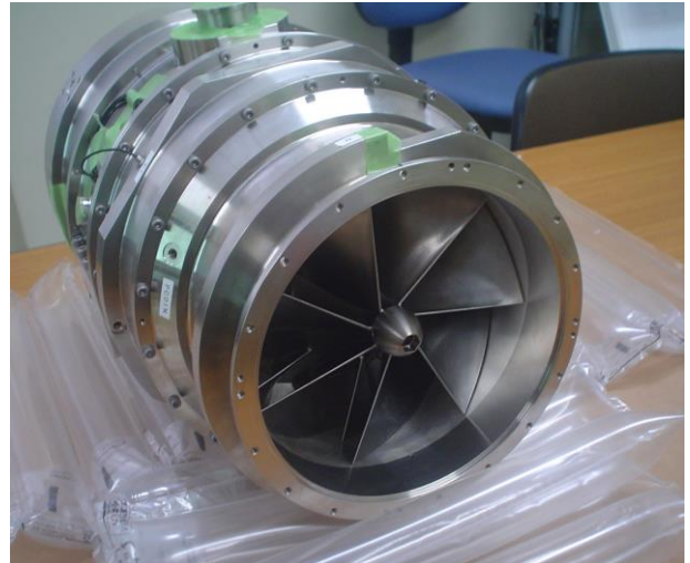
図 8 製作した GG-ATR エンジン
