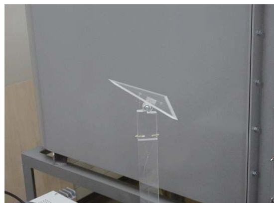
図2:デルタ翼模型
