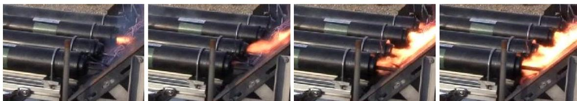
図4 加速用ハイブリッドロケット4本クラスタ時の着火ばらつきの様子（左端から右端まで0.5秒）
