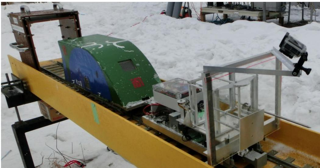
図1 サブスケール高速軌道実験装置に搭載したロバーバル型空力天秤
