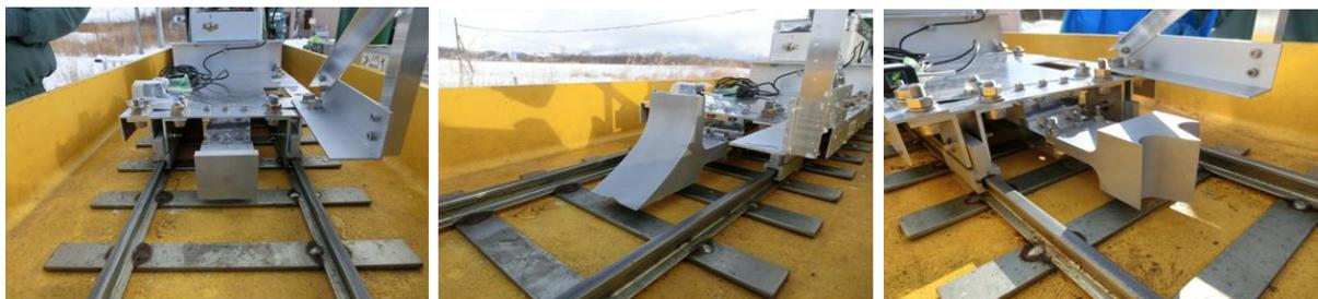
図3 振動を抑制する水制動板の試作（左から 平板バケット、ダウンフォース・バケット、スプリット・バケット）
