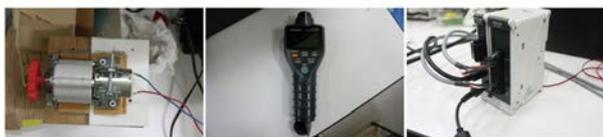
写真2 発電機と増速機 (左), 回転計 (中央) およびデータロガー (右)
