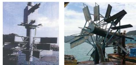
図 7 使用した多段式開閉型水車
