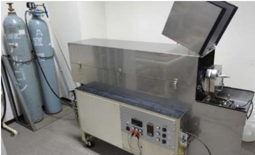
図 2.3.2-1 温間等方加圧装置の外観
