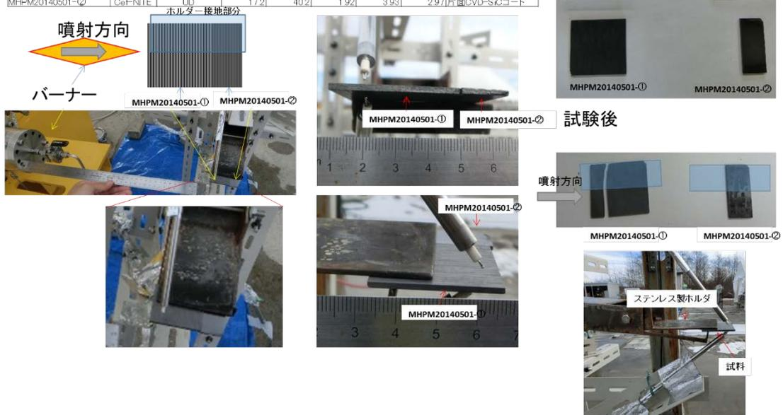
図 4.3.1-1 燃料噴射損傷試験の損傷概要・試料設置方法
