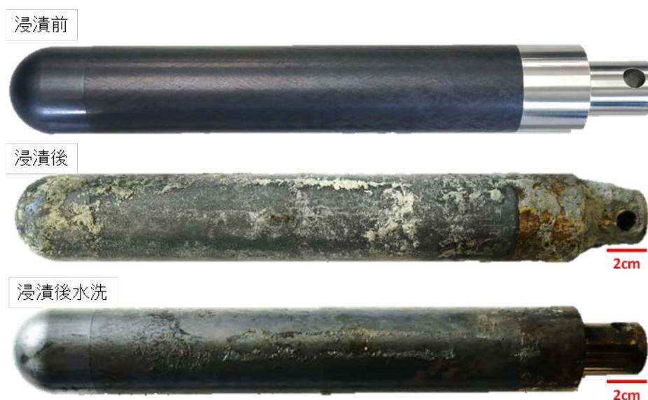
図 5-3-5 奥の湯で浸漬したユニットモデルの浸漬試験前後の様子
