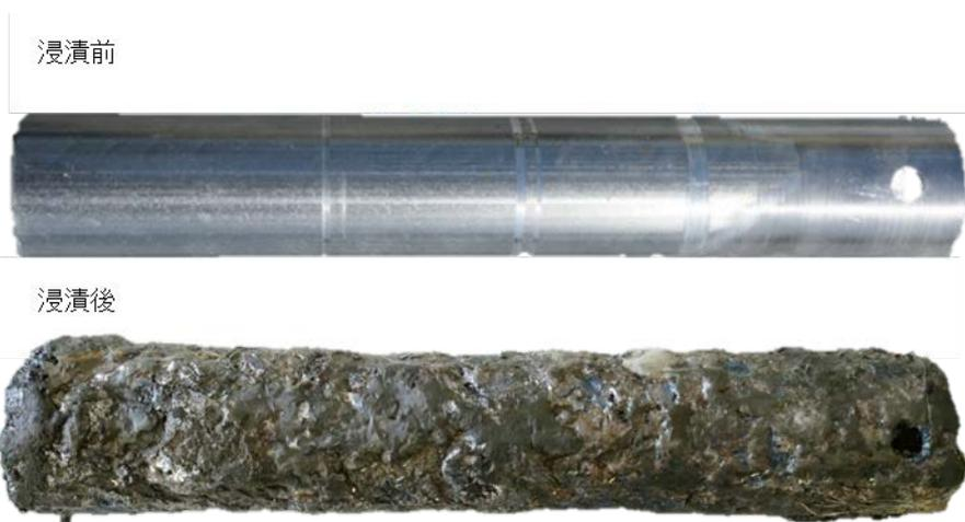
図 5.3-4 奥の湯で浸漬した鋼管（比較材）の浸漬試験前後の様子
