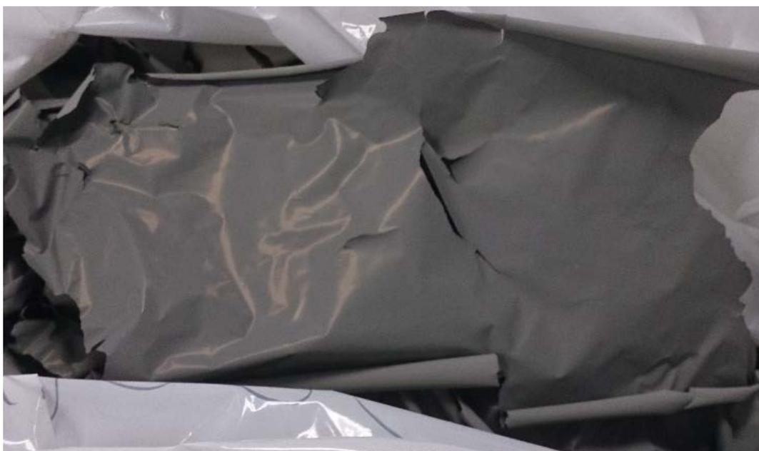
図 2.2.2-2 不適切な条件で製作した SiC グリーンシート
