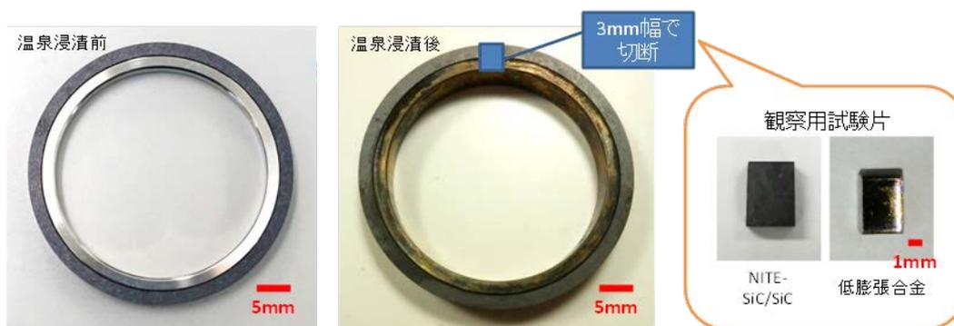
図③-21 奥の湯における浸漬前後の材料評価用リングと、SEM 観察用試験片の外観
