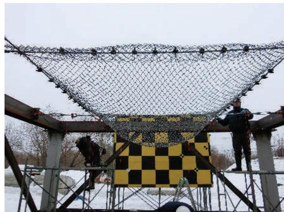
写真7 実験終了後の金網の状況
