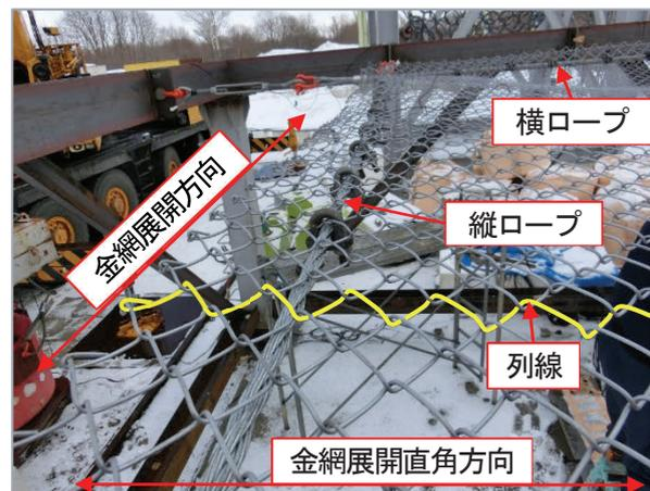
写真2 ひし形金網の構成
