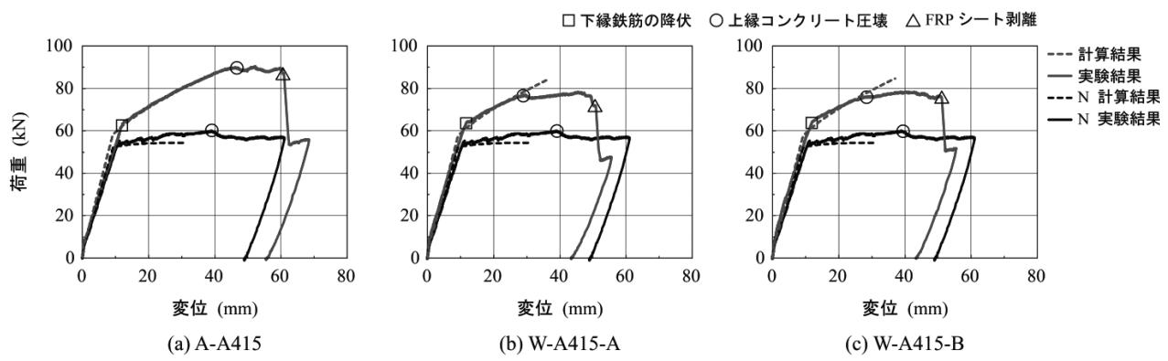
図-3 RC 梁試験体の荷重-変位関係の実験および計算結果の比較
