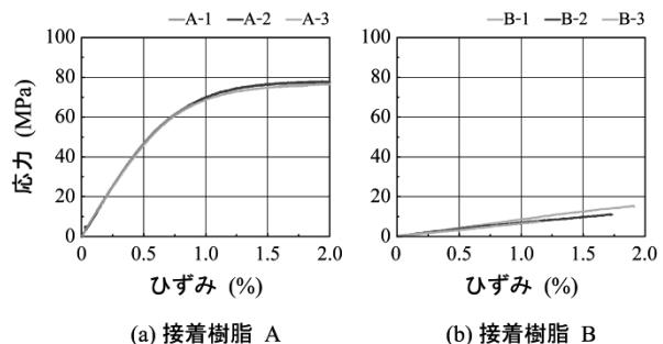
図-2 各試験体の応力一ひずみ関係
