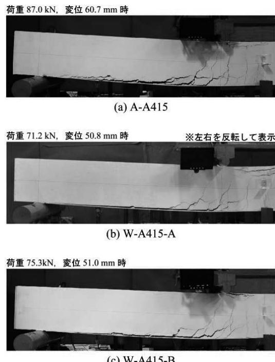
写真-1 剥離直前のひび割れ性状
