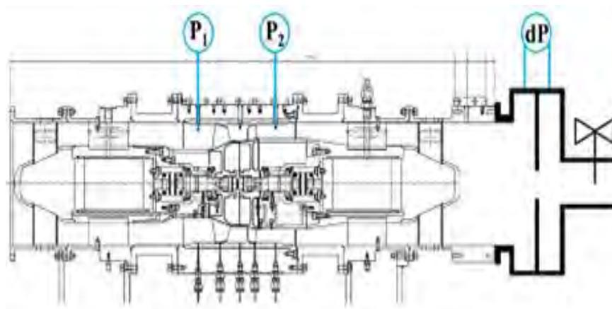
図2 流量計測オリフィスおよび差圧計の取り付け位置
