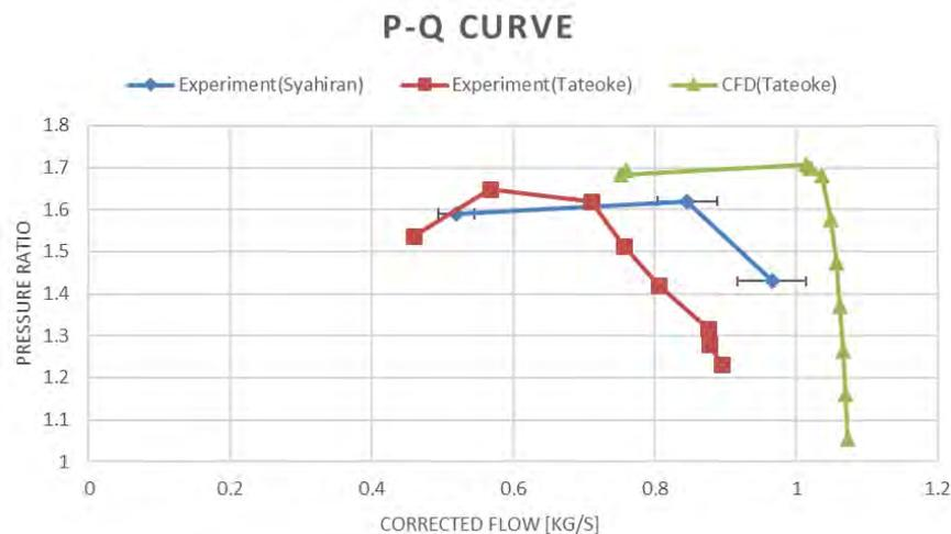
図4 先行研究の実験(赤)・CFD 計算(緑)と本実験(青)の P-Q 特性の比較.
