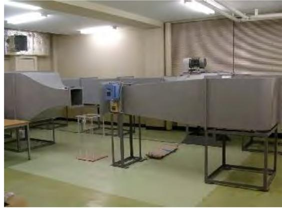
図3 回流式低速風洞
