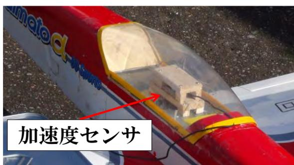
図 3 加速度センサ固定
