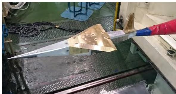
図2 風試模型の遷音速風洞への設置
