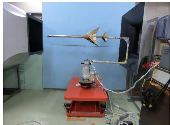
図2 低速風洞に機器を設置した様子
