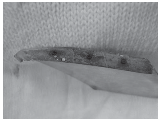
(b) 破損後の垂直尾翼側接合部.
