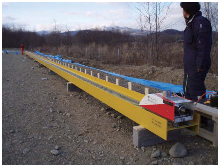
図 1：サブスケール高速走行軌道装置
