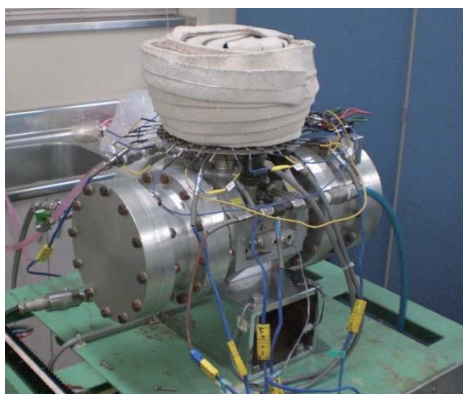
図1: スターリングサイクル発電機(左: 外観 右: 断面図)
