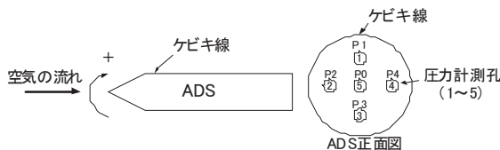
図 4 : ADS 先端部分の模式図
