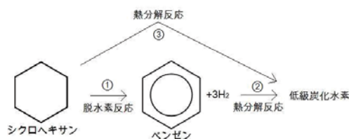
図 1 シクロヘキサン反応経路図
