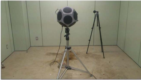
図 2 スピーカ（室内中央）とマイクロフォン
