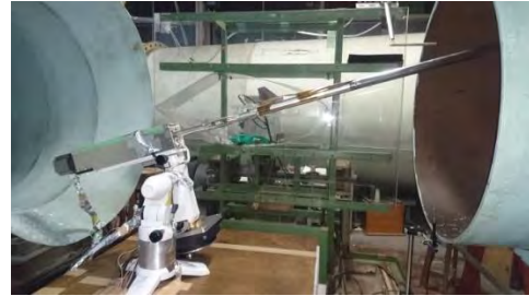
図3 ロール駆動装置の風洞への設置( \theta = 15 \text{ deg} )
