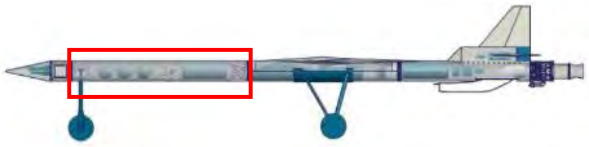
図4 胴体一般部の一体化
