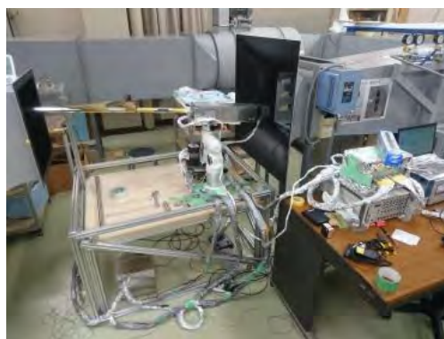
図3 ロール駆動装置と機体模型の風洞への設置 ( \theta = 5\text{deg.} )
