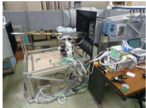
図3 ロール駆動装置と機体模型の風洞への設置 ( \theta = 5\text{deg.} )
