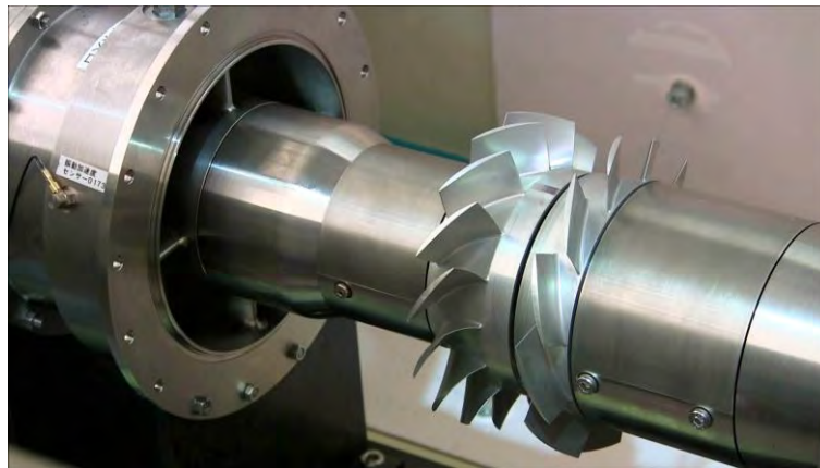
図1 二重反転ファン試験装置（ケーシングを外したところ）
