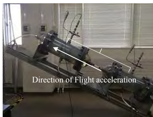
図3 タンクおよび配管系の傾斜の状況
