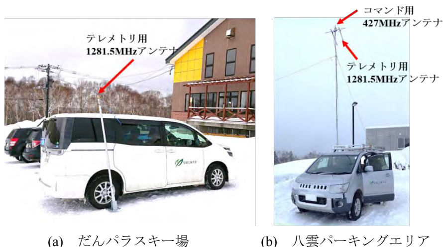
図 4 実験場所での設置状況
