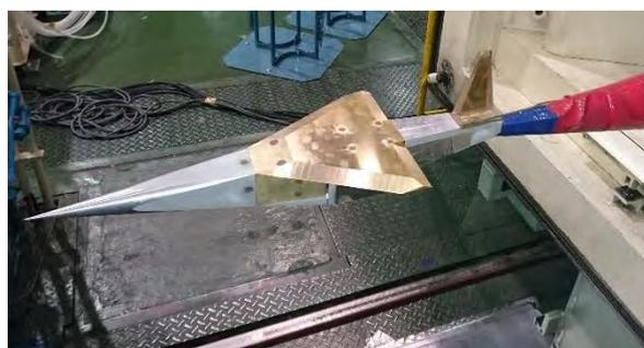
図2 風試模型の遷音速風洞への設置
