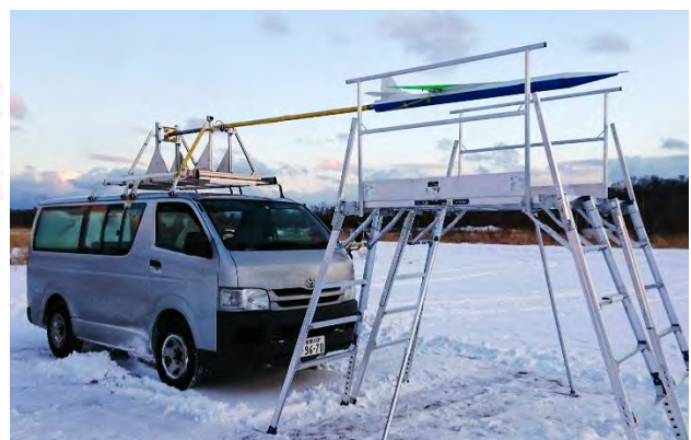
図 2 ワンボックスカーに設置された櫓及び 1/3 スケール縮小機体 (2018 年 1 月)
