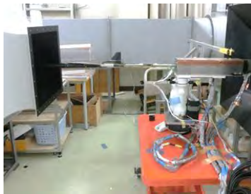
図2 ロール駆動装置，機体模型，および天秤計測系の風洞への設置
