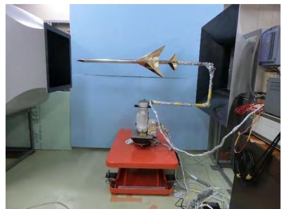
図2 低速風洞に機器を設置した様子
