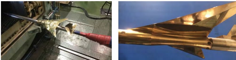
図3 風試模型の遷音速風洞への設置状況
