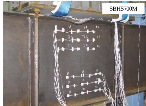
図-17 供試体の荷重後の変形
