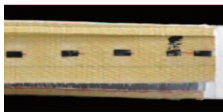
写真－５ A830-S 試験体のシートの断裂・剥離状況
