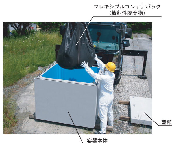
写真-1 放射性廃棄物を格納する RC 製容器
