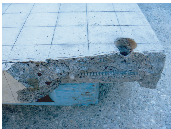
写真-5 タイプI 容器蓋部の損傷状況
