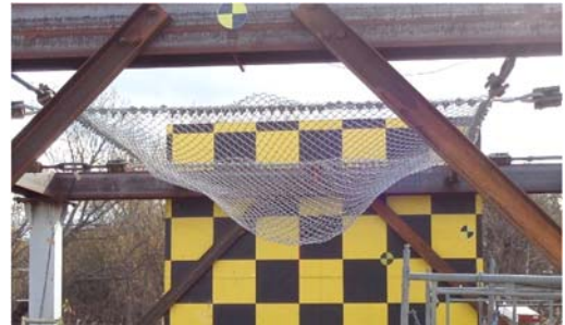
写真-7 実験終了後の金網状況(D4.0W3H10B)
