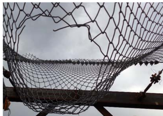
写真-5 金網の破網状況(D4.0W3H25B)
