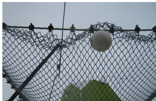
写真-6 金網とワイヤロープの接続部の局所変形 (D5.0W10H3A)
