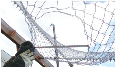
写真-3 実験終了後のひし形金網の破網状況 (D3M3H10 の場合)
