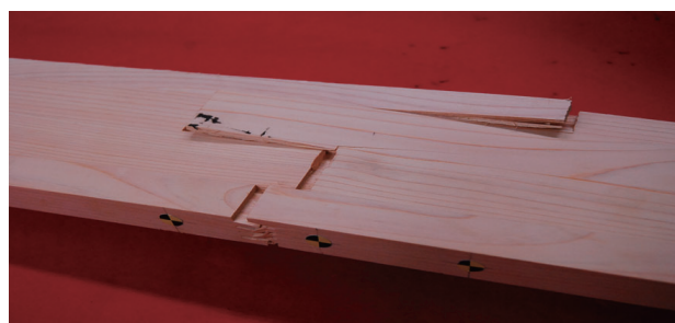
写真-6 無補強試験体の破壊例
