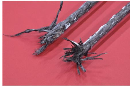
(b) CFRP ロッド破断部の状況
