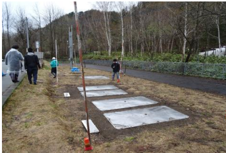
写真-2 積雪重量計（定山溪ダム流木処理場）
