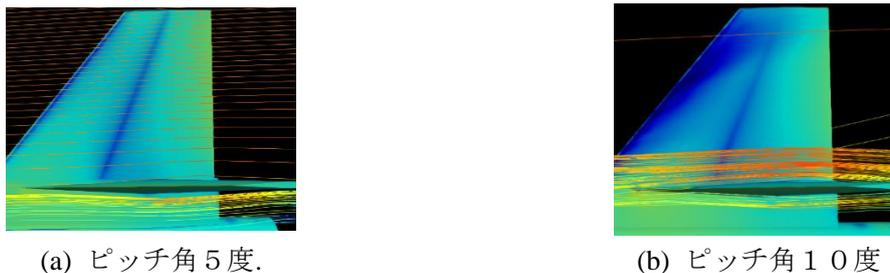
図 2 左エレボン近傍における主翼吹き下ろし流れの様子
